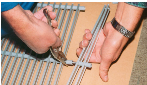
Passaggio 6: accorciare le molle rimanenti della griglia
