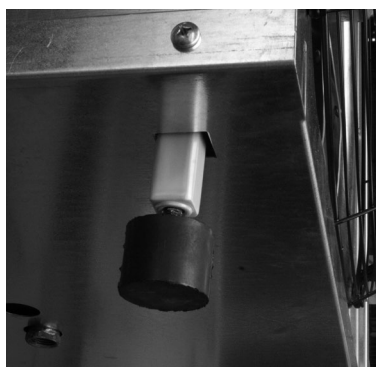
Piede di appoggio nell'esecuzione verticale
