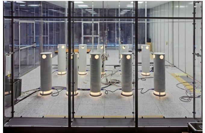
Prova di 10 dummy con regolazione di potenza
