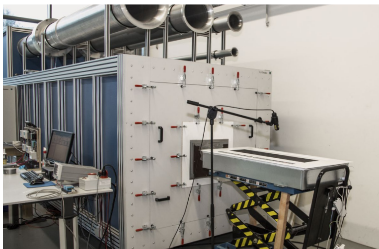
Banco di prova a cabina per misurazioni della portata dell'aria; Kampmann F&E Center
