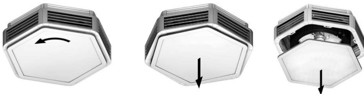
Fig. 12: Smontaggio coperchio dell'alloggiamento
